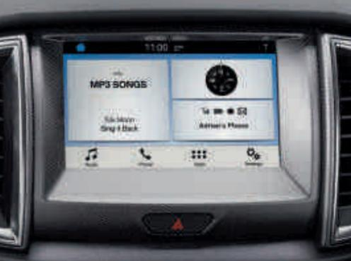
Systém Ford SYNC 2 s 8" dotykovým displejom TFT a hlasovým ovládaním (Štandardná výbava)
