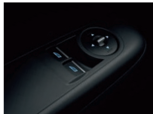
Na jeden dotyk ovládané zdvíhanie/spúšťanie okien na strane vodiča aj spolujazdca s automatickým zatvorením (Štandardná výbava)
