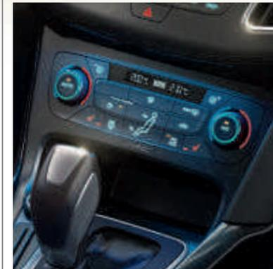
● **Dvojitá klimatizácia s elektronickým automatickým riadením teploty (DEATC)**
